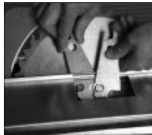
Sägeblatt-Flanschschraube öffnen. Linksgewinde!
