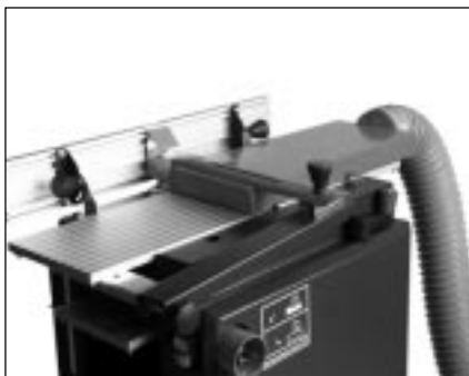
Ordnungsgemäße Betriebsstellung zum Dickenhobeln
