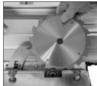
Sägeblatt von oben einführen.
