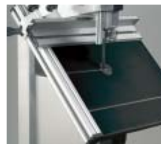
Schwenkbarer Präzisions- Alu-Druckgusstisch
