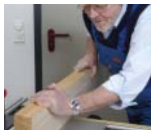
Abrichthobeln: Das innovative FIXTABLE-System erspart das umständliche Aufklappen der Hobeltische und sorgt für mehr Sicherheit.
