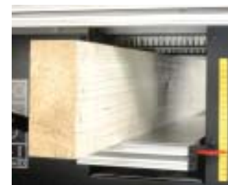
Dickenhobeln: Automatischer Vorschub durch material-schonende Gummi-Einzugschwalze. Durchlasshöhe bis zu 185 mm.
