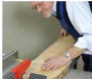
Formatsäge: Mit integriertem, kugelgelagertem Schiebetisch zum bequemen Besäumen.
