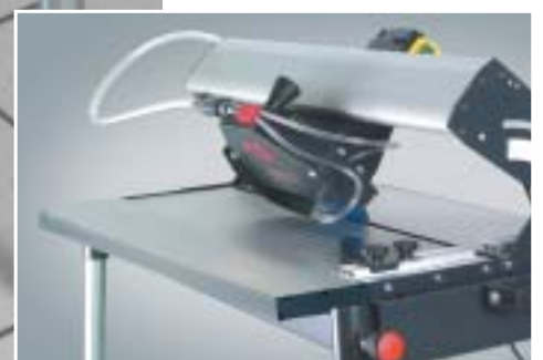
POWERCUT plus mit Zubehör Tischverbreiterung
