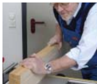
Abrichthobel: Das innovative FIXTABLE-System erspart das umständliche Aufklappen der Hobeltische und sorgt für mehr Sicherheit.
