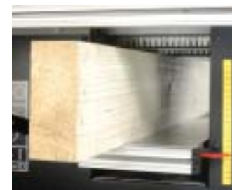
Dickenhobel: Automatischer Vorschub durch material-schonende Gummi-Einzugschwalze. Durchlasshöhe bis zu 185 mm.
