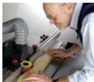
Schleifen: Der Universalfräser kann gegen eine höhen- und schrägverstellbare Schleifwalze ausgetauscht werden. Die hohe Umdrehung gewährleistet einen absolut sauberen Schliff.
